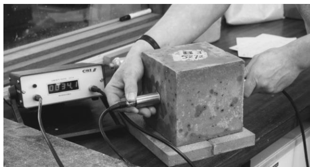
Figuur 7.7 Betontester: bepalen van de geluidssnelheid door een kubus.
