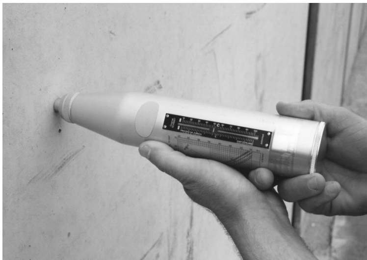
Figuur 7.6 Terugslaghamer "systeem Schmidt" voor onderzoek aan de constructie.
